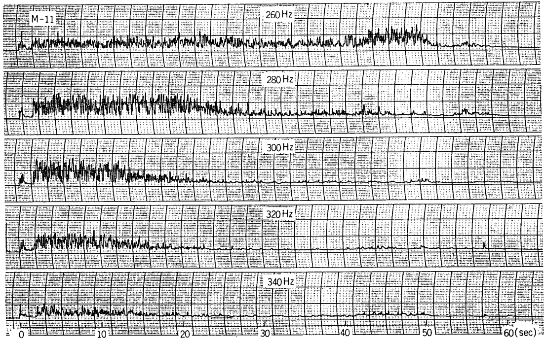
図 8-2 M-11 の内圧振動 (周波数分析-3)
