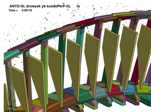
CMC 低圧タービン動翼列の解析結果例
