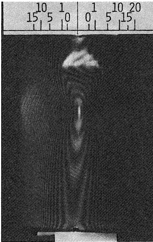
第 13(c)図 楕円筒殻(E2-11)の c 点におけるモアレ写真と変位等高線
