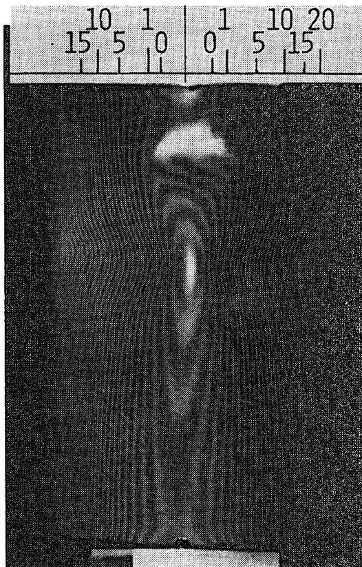
第 13(b)図 楕円筒殻(E2-11)の b 点におけるモアレ写真と変位等高線
