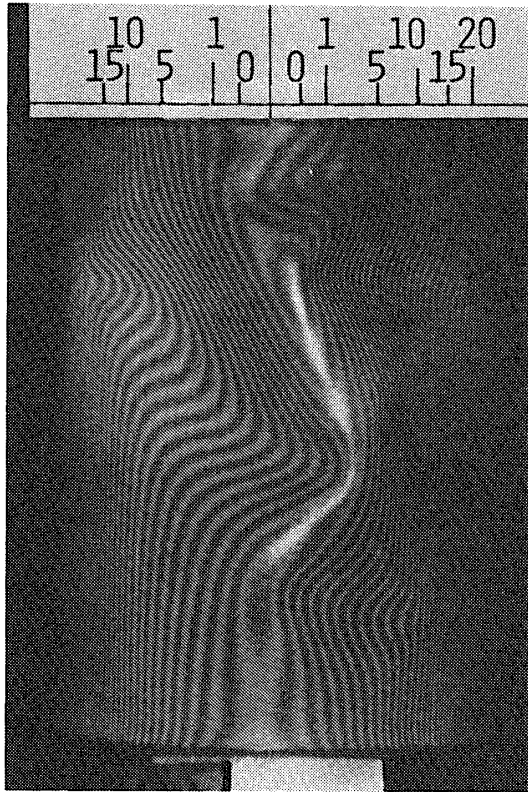
第 14(d)図 楕円筒殻(E3-11)のd点におけるモアレ写真
