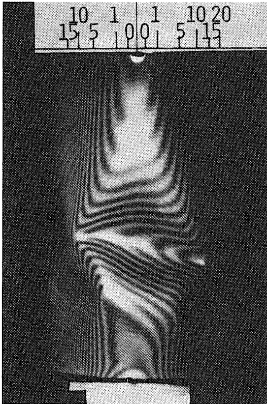
第 12(d)図 楕円筒殻(E1-11)のd点におけるモアレ写真と変位等高線
