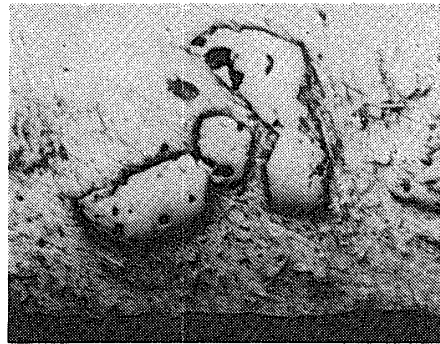
第12図 Al-Fe 焼結体 (10 vol% Fe, 800 °C × 20 min)
