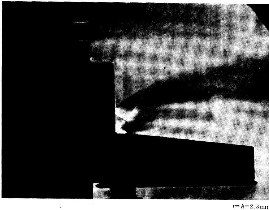
図-6 タングステン半球体突出時のノズル流シュリーレン写真例
