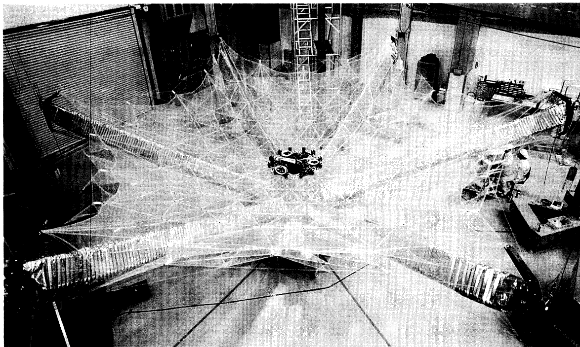
図1 大型展開アンテナの主反射鏡
