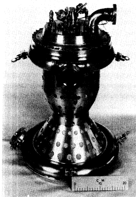
図1 7トン管構造燃焼器 TC-701
