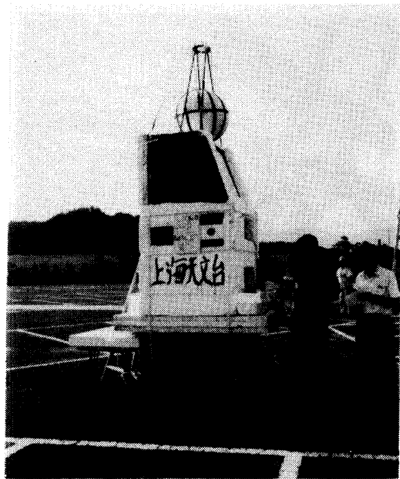
写真 3 放球直前のテストを行う、上海天文台の銀河赤外観測器 (B 30-C 5)。
