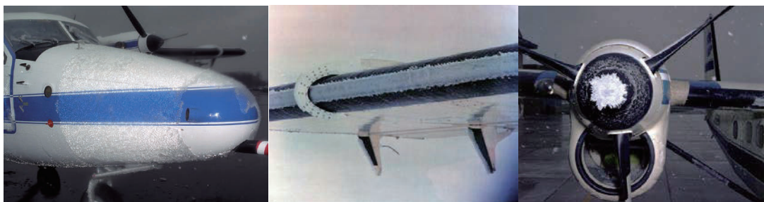
Fig.4.2-2 機首（左）翼（中）スピナー（右）への着氷（右） 4.2.3)-4.2.5)
