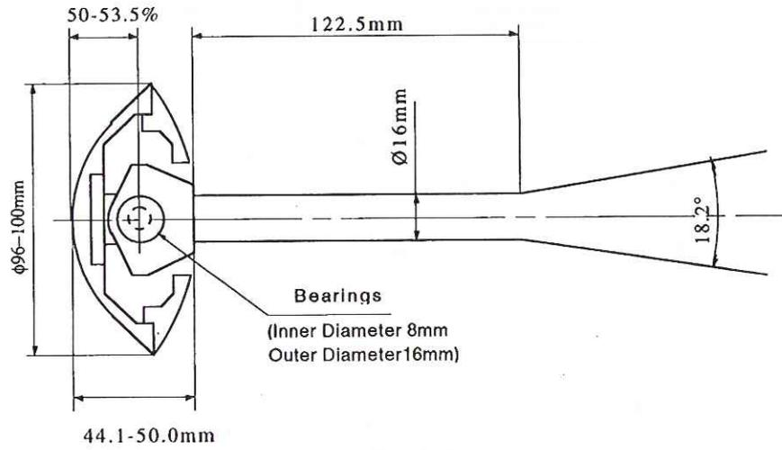
Fig. 13: Test apparatus.
