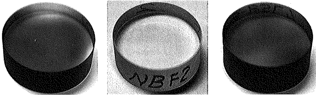
図12：70MeVプロトンを照射した後のガラス材の着色化の様子 (左) CaF 2 (UV grade)、(中央) NBF 2 、(右) S-BSL7。照射前のガラス材の発色はほぼ無色透明であり、殆ど着色化が発生しなかったNBF 2 (中央) の発色と同様であった。
