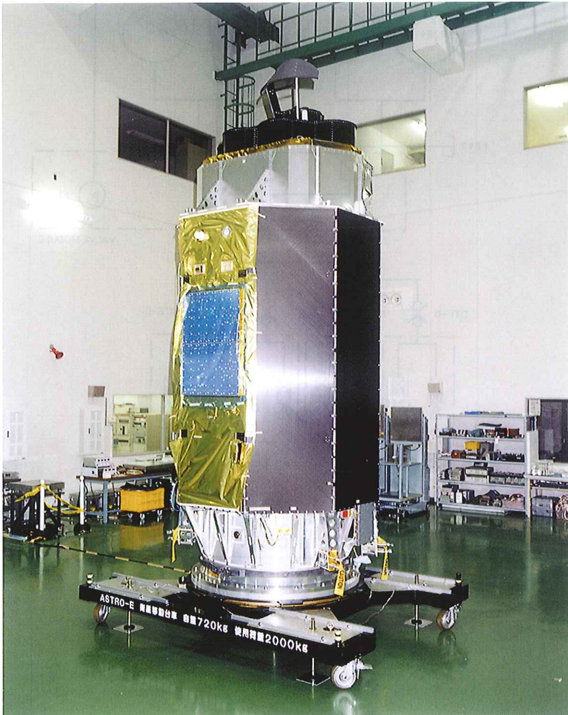
図 5-29 「ASTRO-E」 RCS 外観写真 (衛星下部のスラスタ)
