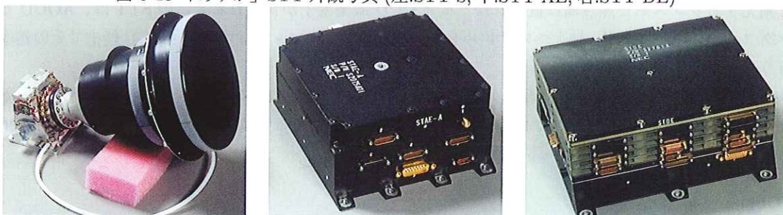
図 5-10 「あすか」 STT 外観写真 (左:STT-S, 中:STT-AE, 右:STT-DE)
