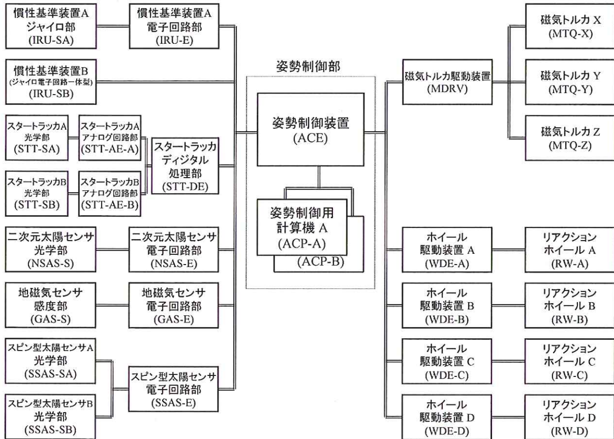
図 3-1 「あすか」姿勢制御系の機器構成
