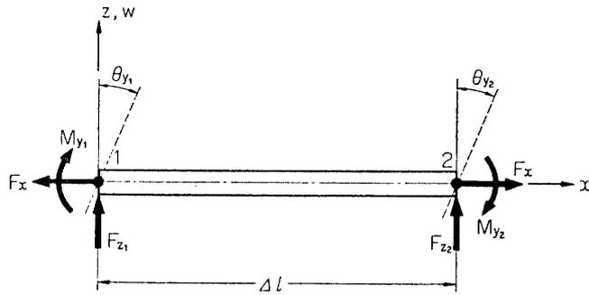
FIG. 3.3.1. Beam Element.
