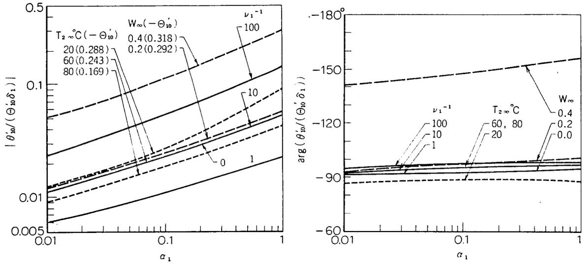
FIG. 4.5. Disturbance temperature gradient at the interface (Water-air,  $T_{1\infty}=100^\circ\text{C}$ ,  $c=0$ ; —,  $T_{2\infty}=60^\circ\text{C}$ ,  $W_\infty=0$ ; ----,  $\nu_1^{-1}=10$ ,  $W_\infty=0$ ; -.-,  $T_{2\infty}=60^\circ\text{C}$ ,  $\nu_1^{-1}=10$ ).
