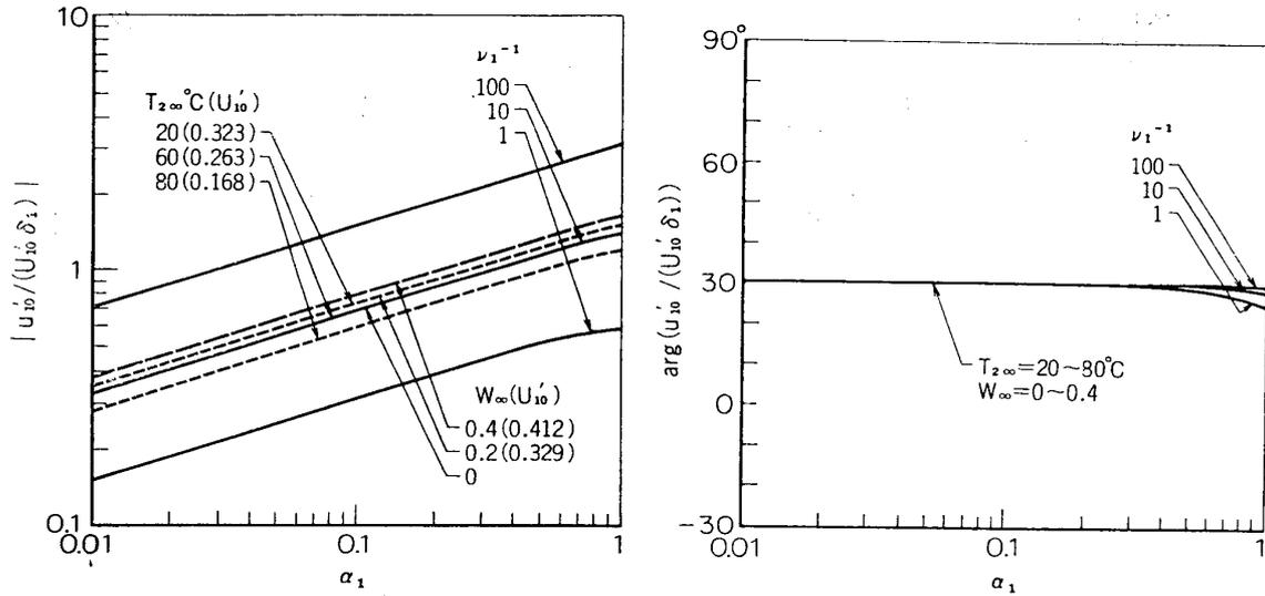
FIG. 4.3. Disturbance velocity gradient at the interface (Water-air,  $T_{1\infty}=100^\circ\text{C}$ ,  $c=0$ ; —,  $T_{2\infty}=60^\circ\text{C}$ ,  $W_{\infty}=0$ ; - - -,  $\nu_1^{-1}=10$ ,  $W_{\infty}=0$ ; - · - ·,  $T_{2\infty}=60^\circ\text{C}$ ,  $\nu_1^{-1}=10$ ).
