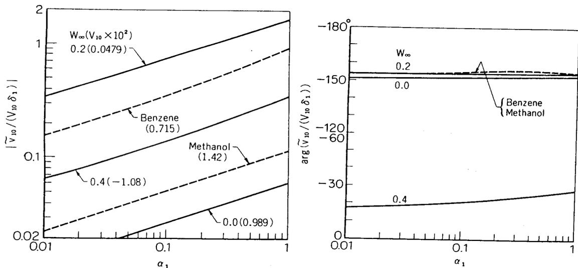
FIG. 4.2.2. Disturbance rate of phase-change (Air,  $T_{1\infty}=100^\circ\text{C}$ ,  $c=0$ ,  $\nu_1^{-1}=10$ ; —, water,  $T_{2\infty}=60^\circ\text{C}$ ; ----,  $T_{2\infty}=40^\circ\text{C}$ ,  $W_\infty=0$ ).
