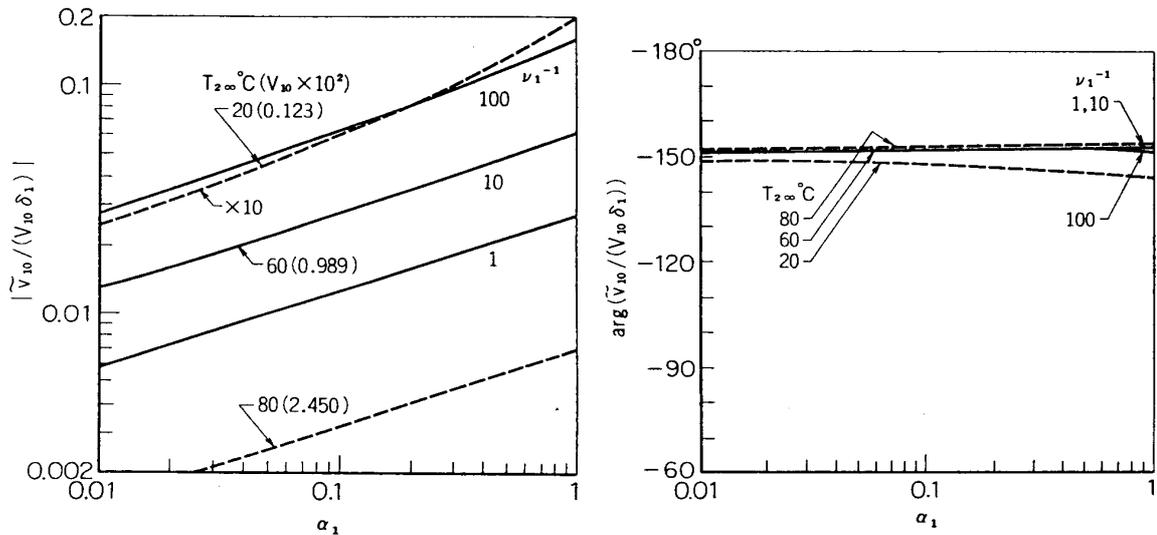
FIG. 4.2.1. Disturbance rate of phase-change (Water-air,  $T_{1\infty}=100^\circ\text{C}$ ,  $c=0$ ; —,  $T_{2\infty}=60^\circ\text{C}$ ,  $W_\infty=0$ ; ----,  $\nu_1^{-1}=10$ ,  $W_\infty=0$ ).
