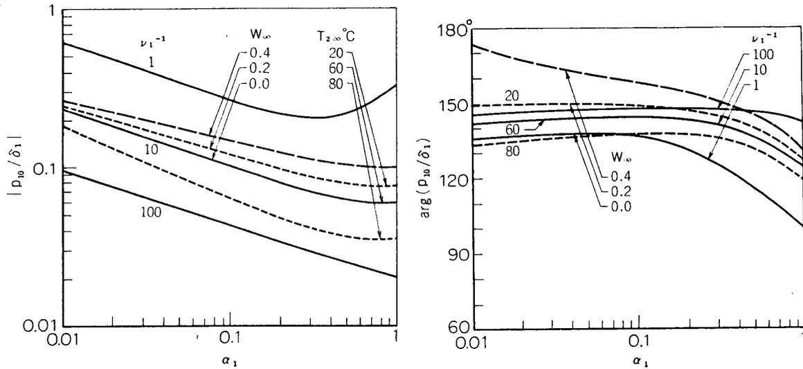
FIG. 4.4. Disturbance pressure at the interface (Water-air,  $T_{1\infty}=100^\circ\text{C}$ ,  $c=0$ ; —,  $T_{2\infty}=60^\circ\text{C}$ ,  $W_\infty=0$ ; - - - ,  $\nu_1^{-1}=10$ ,  $W_\infty=0$ ; - · - · ,  $T_{2\infty}=60^\circ\text{C}$ ,  $\nu_1^{-1}=10$ ).
