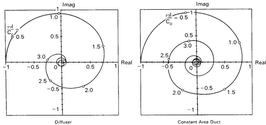
FIG. 10. Reflection Coefficient  $\chi$
