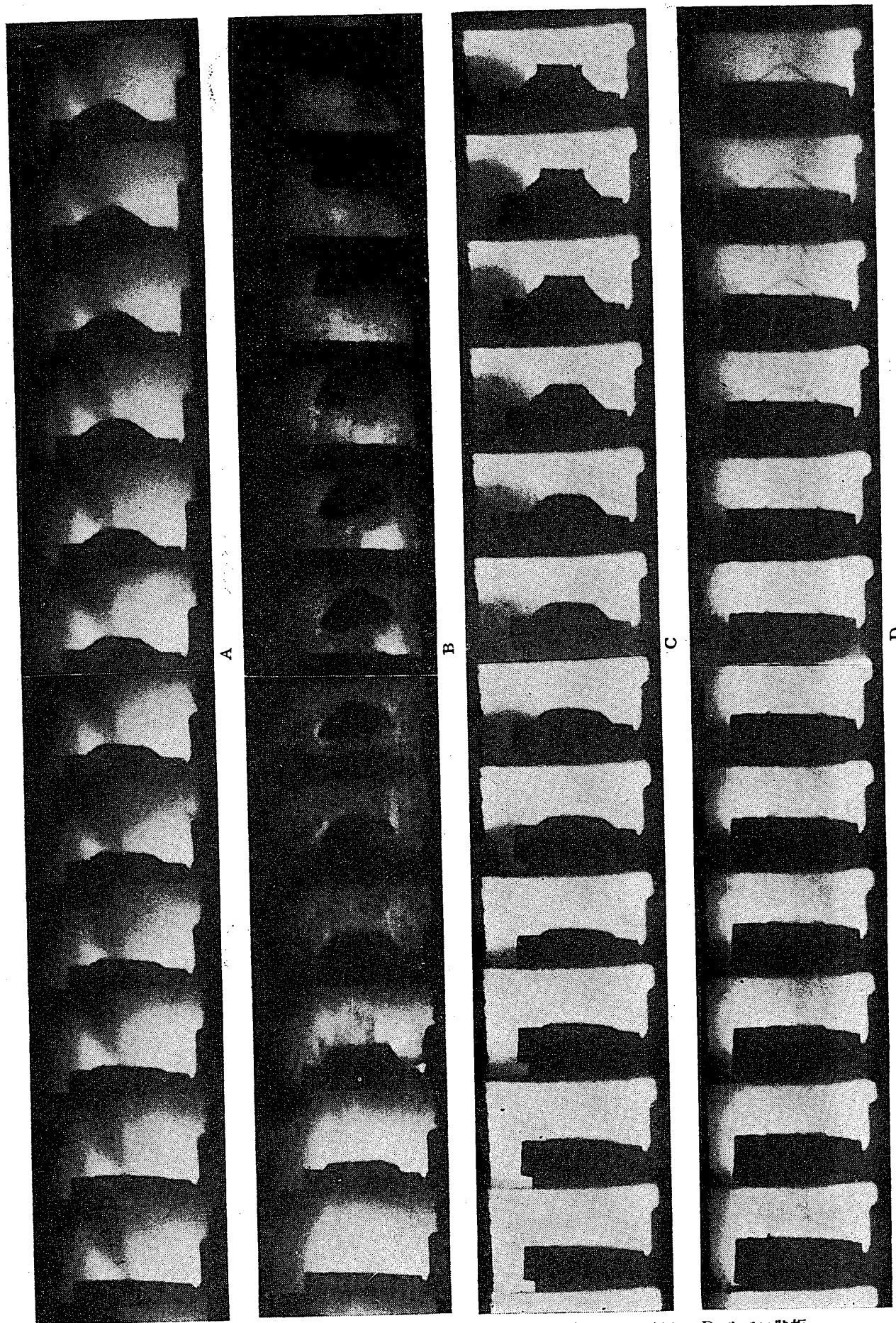
第 5 図 撮影結果 A 凹形板, B 凹形板 (切斷), C 有孔凹形板, D リボン状板.
