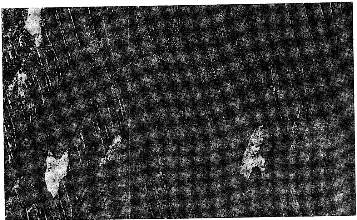
写真 6. 交叉雙晶部分に発生した新結晶粒 (232°C, 2 時間焼鈍), \times 9
