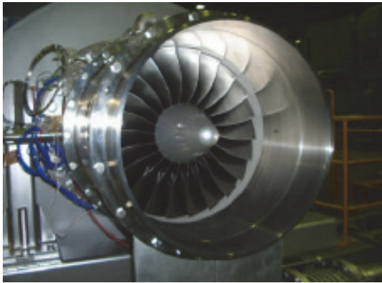
図4 ファン空力性能実証試験モデル
