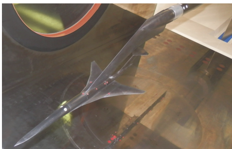
図6. 上方支持された風洞試験模型
