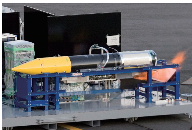
図 2.5-5 極超音速ターボジェット地上燃焼実験
