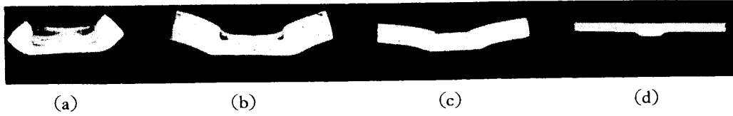
第 4・2・3 図 平らな台上で円柱ポンチ押込を受けた円板素材
