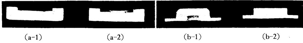
第 4・2・8 図 コンテナ内で押込および角出圧印を受けた薄い材料の断面. 硬アルミニウム (a-1) (b-1) は押込から圧印への過渡段階 (a-2) (b-2) は最終圧印段階.
