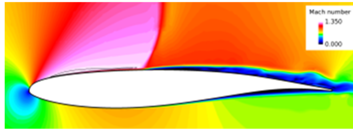
図1 OAT15A翼型のバフエット解析 : Buffet analysis of OAT15A airfoil
