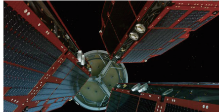
磁気圏観測衛星SWARM同時分離(出典:ESA) →Rokotロケット(露)、衛星質量1機約500kg
