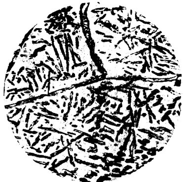
Fig. 1 b Fe 59 Ni 30 Al 11 1300°→w.q. 1200°→w.q. ×240
