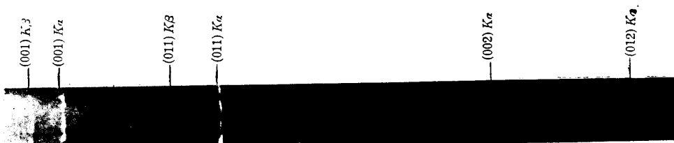
Fig. 8c Fe 61 Ni 30 Al 9 (lump-annealed) (Cr-ray)
