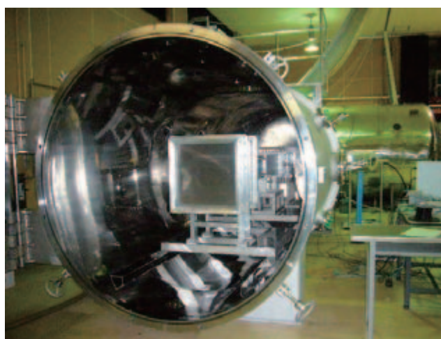
図1 火星大気風洞. 低レイノルズ数における高亜音速風洞試験が可能な装置.
