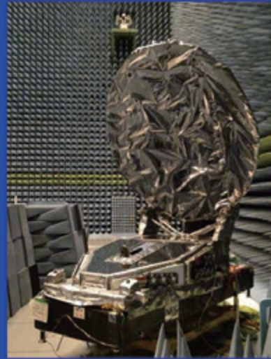
CPRプロトフライトモデル @筑波宇宙センター、電波試験棟
