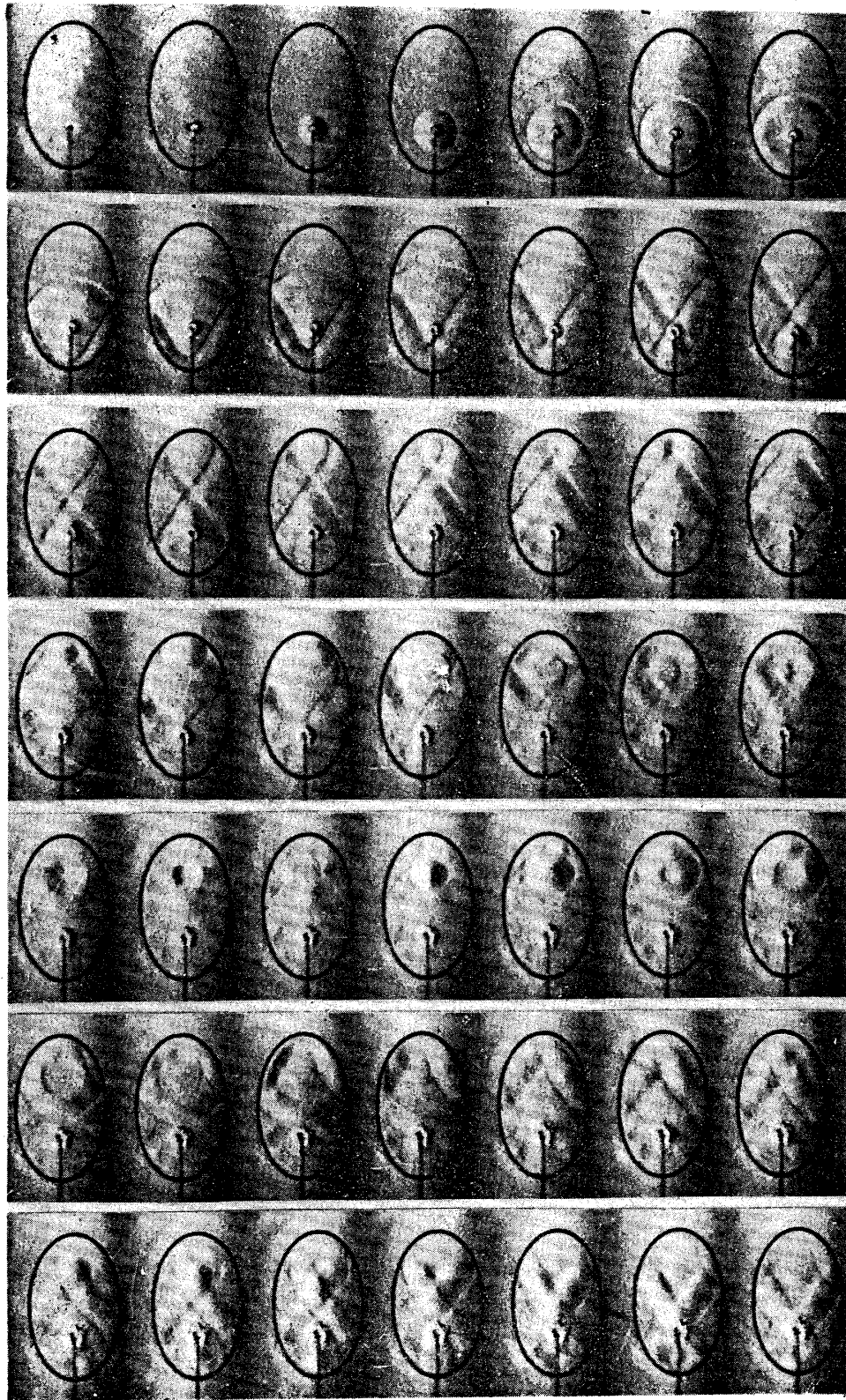
第十三圖 楕圓筒内の音波、毎秒40,500回の割合で撮影
