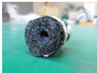
通風後アブレータ前面
