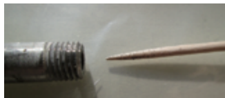
圧力配管中の付着物
