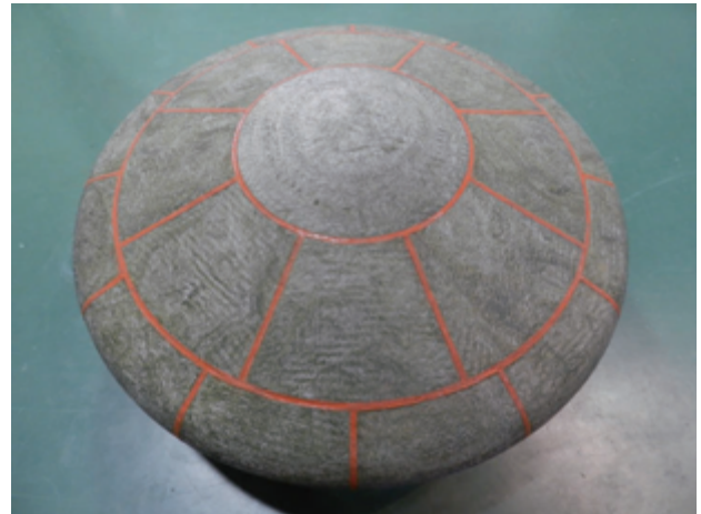
図 13 火星着陸探査技術実証エアロシェル BBM
