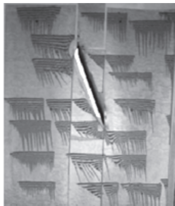
第7図 干渉法によるボルテックスジェネレータまわりの表面摩擦抵抗計測
