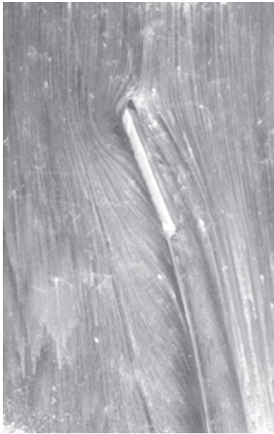
第5図 通常のオイルフローによるボルテックスジェネレータまわりの流れの可視化
