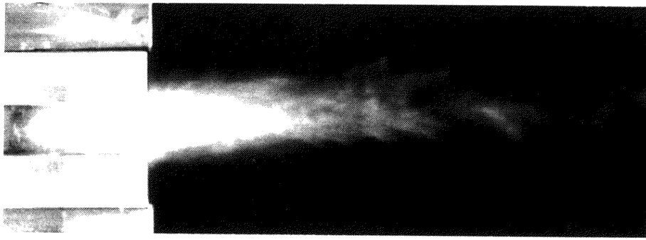
図4 Counter-rotationの縦渦列とブタンジェットの干渉
