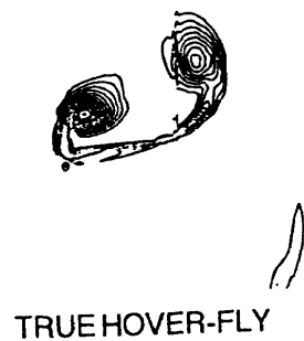
図 14 干渉が無い場合のトンボの前翼まわりの流れの様子と True Hover-Fly の翼まわりの流れの様子 (等渦度線図) の比較
