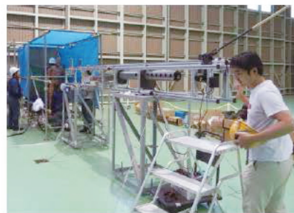
平林 大輔 無人機(5kg)の人体衝突につい てダミー測定を実施
