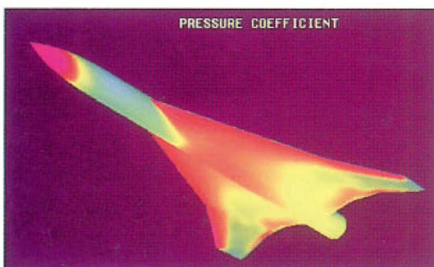
図3 機体下面圧力分布 (ケース7)
