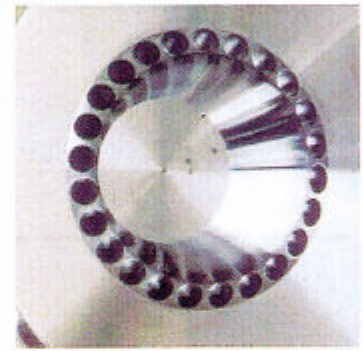
(c) 20%長さのノズルを持つ 24モジュールから構成される エアロスパイクノズル
