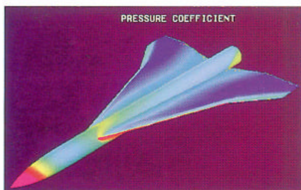
図2 機体上面圧力分布 (ケース7)
