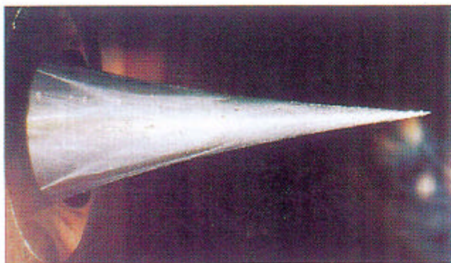
図 8(a) 最大長さの 6 モジュールエアロスパイクノズルの高高度条件におけるノズル表面 SSLC 可視化像
