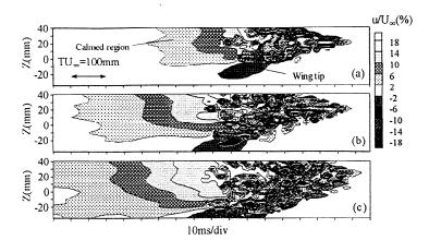
図 1 単独斑点における速度変動 u の Z-T 断面分布の流れ方向変化.  $Y/\delta$  = 0.4, (a) X=300mm, (b) X=400mm, (c) X=500mm.
