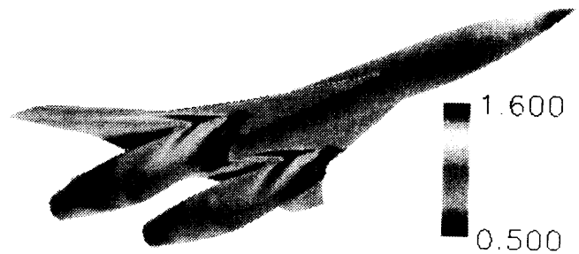
図 13. NAL ナセル付き超音速旅客機モデルに対するオイラー計算例：自由流マッハ数 2.0, 迎角 0 度でのときの圧力分布
