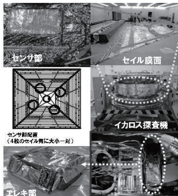
図 イカロス探査機に搭載されたALADDINのシステム構成
