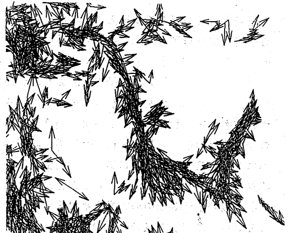
図8 高渦度格子点における渦度ベクトルと速度ベクトル 図7の四角で囲まれた領域を拡大して高渦度領域（渦管）に含まれる格子点上で渦度ベクトルと速度ベクトルを描く。
