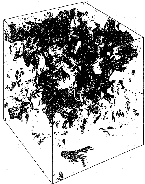
図9 温度場の高勾配領域が空間的に集中する形状 R = 2000, Pr = 1, t = 10 。等高線は 3.0 < H > の高さを示す。
