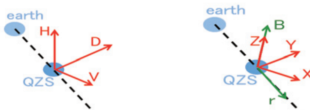
図 4 (左)VDH 座標系の 3 成分。H 軸を地球のダイポール軸と平行で北向きに、D 軸を H 軸と地球の中心と衛星の中心を結ぶ線を両方に垂直で東向きに、V 軸を D 軸と H 軸の外積でとる。(右)FA 座標系の 3 成分。Z 軸を衛星の位置での主磁場と平行の方向に、Y 軸を Z 軸と r 軸 (地球中心と衛星中心を結ぶ軸) との外積で、X 軸を Y 軸と Z 軸との外積でとる。
