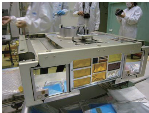
図 9 ExHAM との適合性試験の様子
