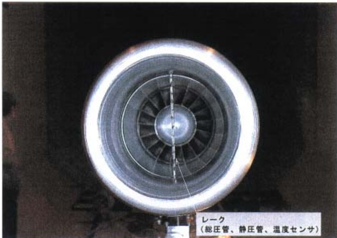
写真 2-2 インテーク部の吸気流計測レーク (正面)
