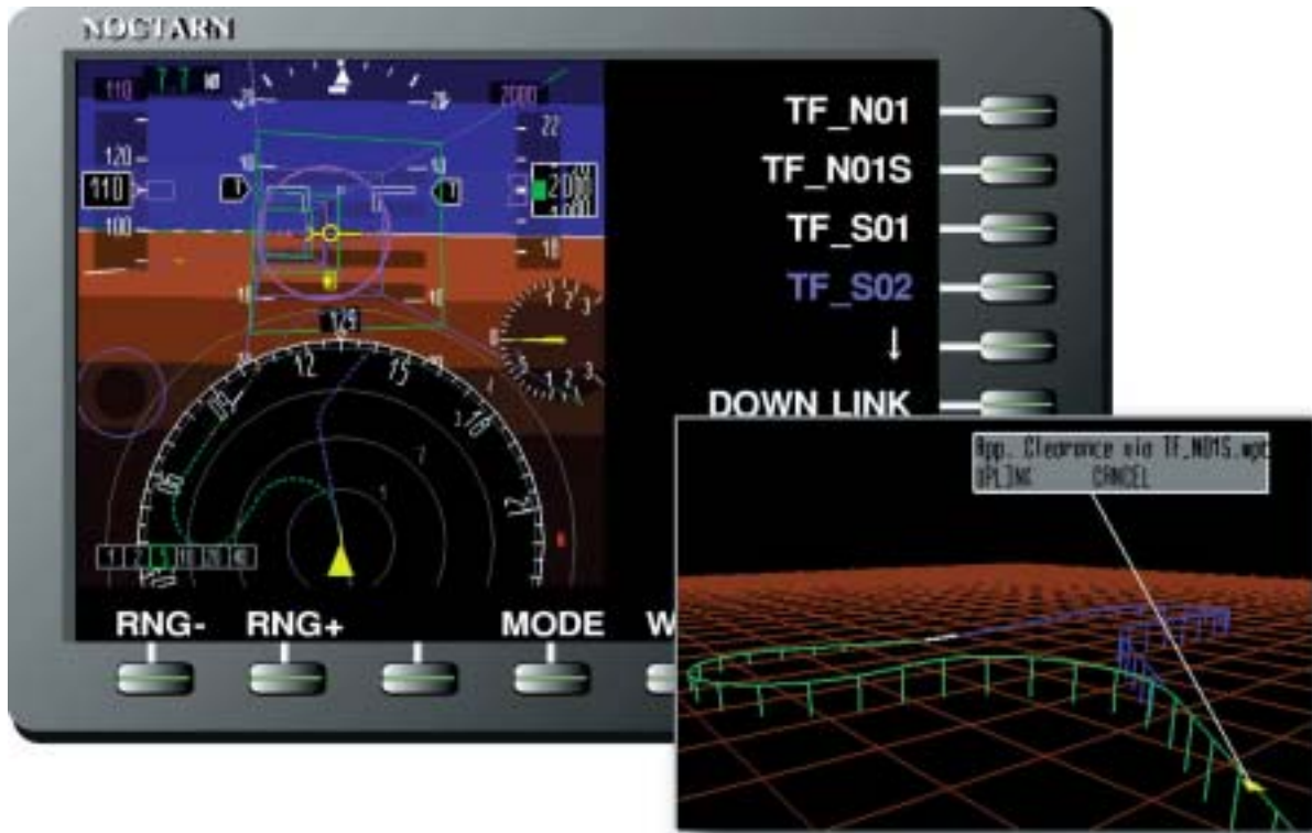
図2 パイロット・ディスプレイの例（緑は現在の経路、青は変更中の経路を示す。 右下は第三者視点からのイメージ） （P35 論文2 適応型飛行経路を用いた次世代運航方式の研究）
