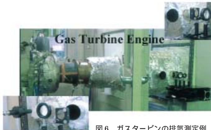
図6 ガスタービンの排気測定例
