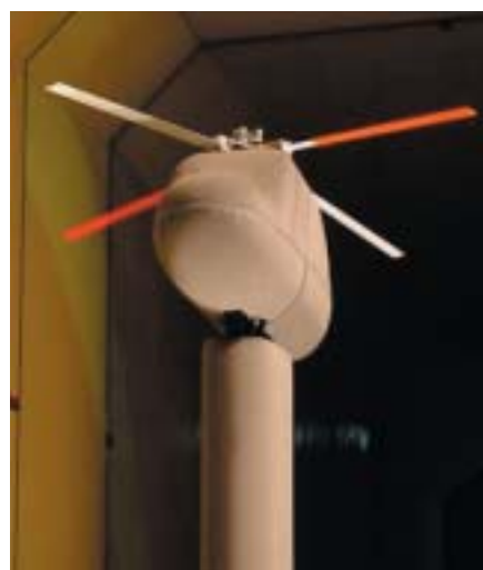
図 1 回転翼試験装置外観
