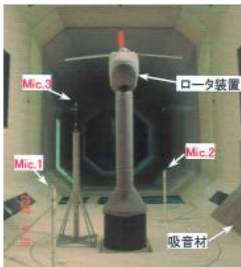
図5 マイクロフォン設置状況写真
