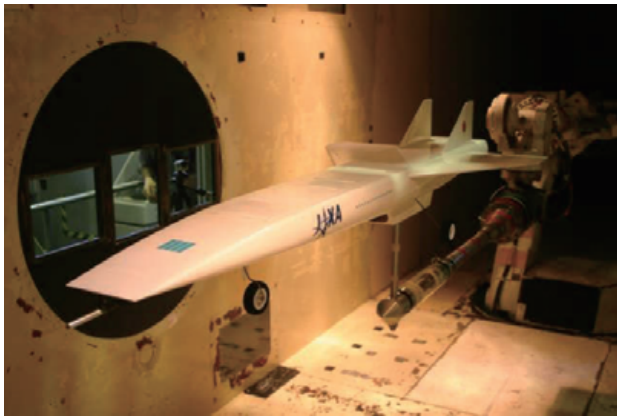
図5 風洞内に設置された供試体
