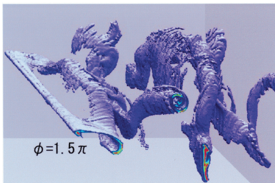
図5 円柱上面から溶出色素が示す渦核構造 (位相抽出3D合成画像)
