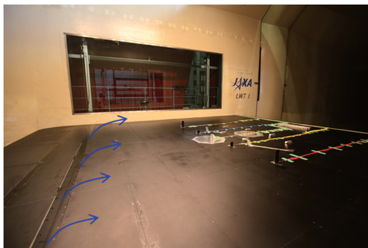
図3 境界層厚さ計測試験時の様子
