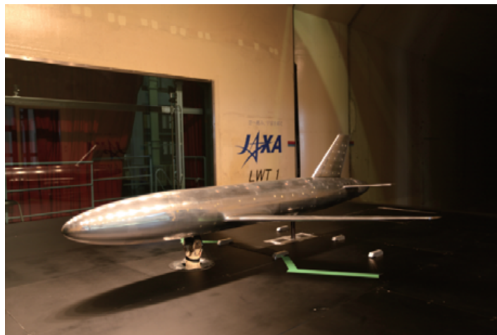
図 8 地面効果確認試験時の様子
