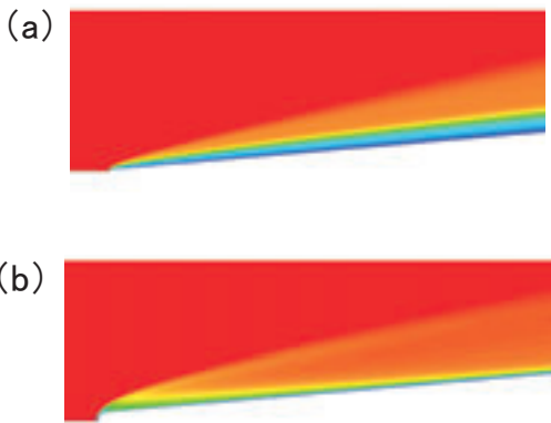
図9 マッハ数分布 (a) Sharp Nose (b) Blunt Nose
