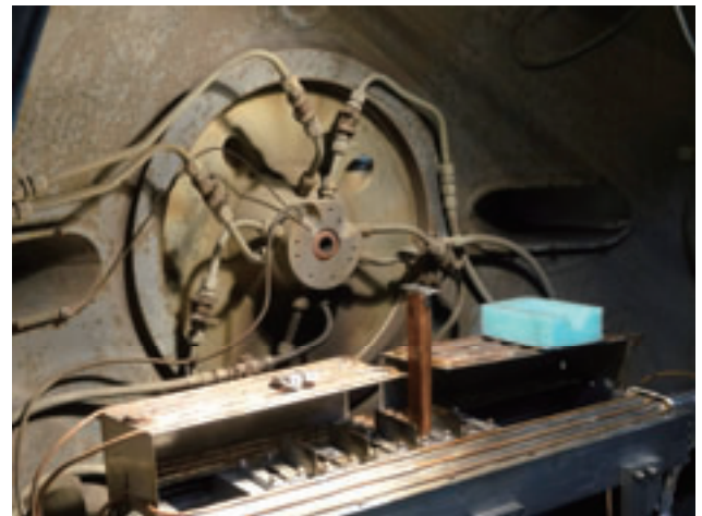
図11 アーク風洞の試験室内。加熱器のノズルと供試体を5個順次投入できる射出装置が分かる
