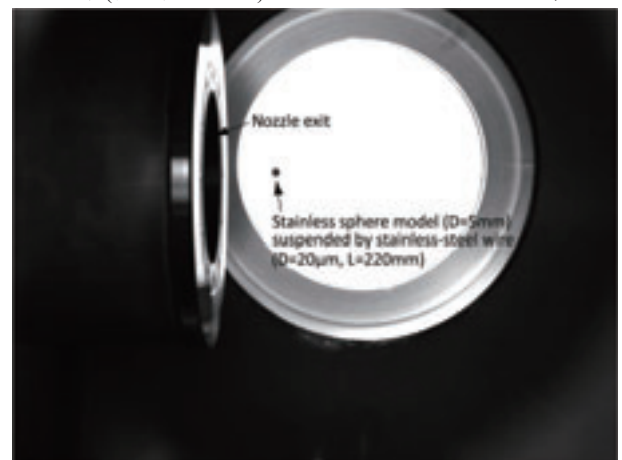
図 3: 吊り下げ式による 5 mm ステンレス球模型の計測写真。
