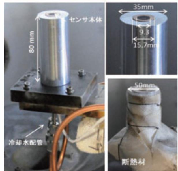
図9 熱流束センサのセットアップ
