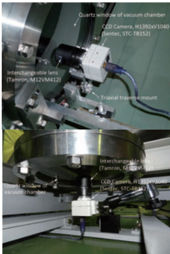
図 2: HRWT 変位計測システム：側面 CCD カメラ(上)、底面 CCD カメラ(下)。
