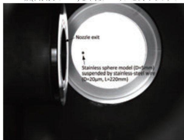
図 3: 吊り下げ式による 5 mm ステンレス球模型の計測写真。
