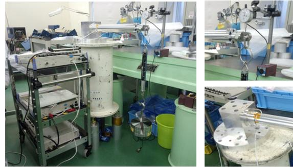
図 9 曲げ試験の状況
